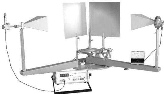
图 3-10 迈克尔逊干涉实验仪器的布置
