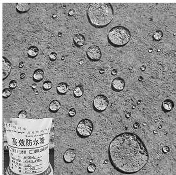
图 1-3 防水混凝土
