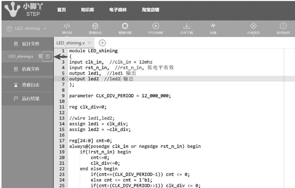
图 3.57 STEP FPGA 线上开发平台-设置顶层文件页面
