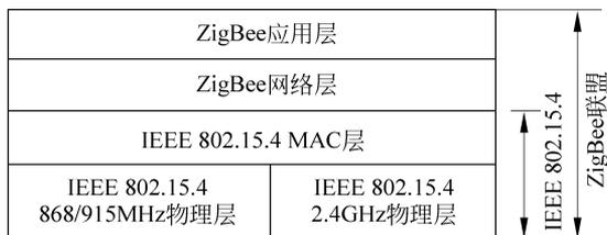
图 5-5 ZigBee 协议栈体系结构模型
