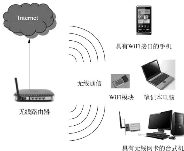
图 5-1 基于接入点模式的 WiFi 组网示意图
