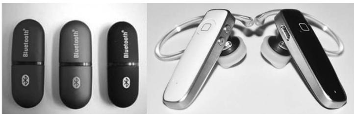
图 5-2 蓝牙技术的适配器和蓝牙耳机
