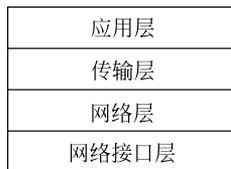
图 5-23 TCP/IP 协议栈结构
