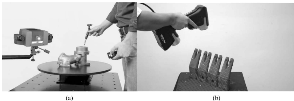
图 3.1 接触式 3D 扫描仪和手持式非接触式 3D 扫描仪
