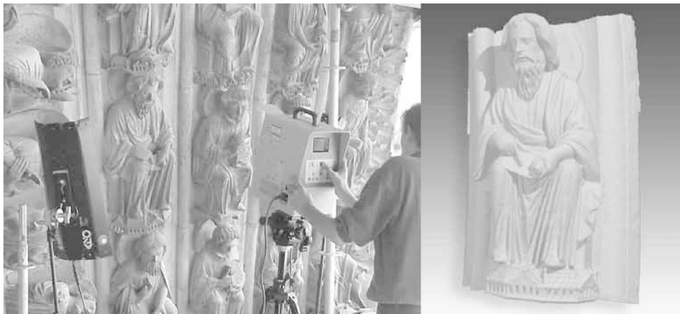
图 3.5 激光扫描仪对雕塑进行非接触性建模
