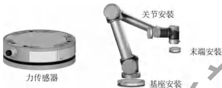
图 1-4 协作机器人六维力传感器及其安装方式
