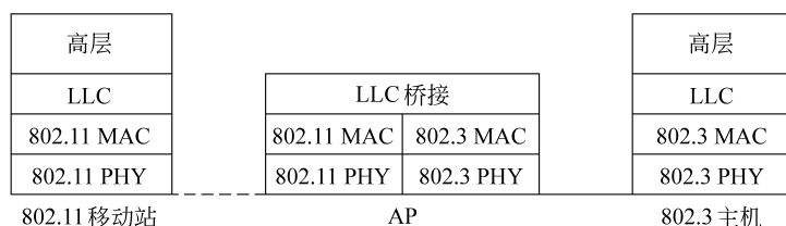
图 5.3 移动站通过 AP 接入以太网的协议结构
