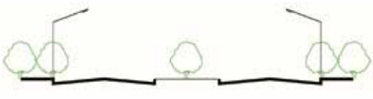
图1-20 二板三带式剖面图
