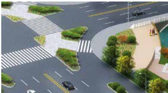
图1-54 采用低矮灌木配置的安全岛设计
