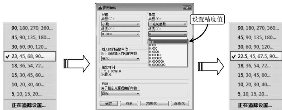
图 3-45 图形单位与极轴捕捉的关系
