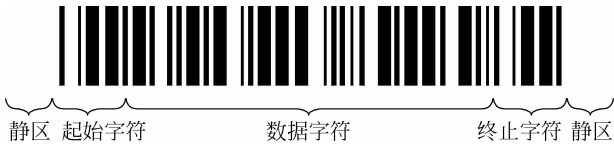
图 3-30 条形码的组成结构
