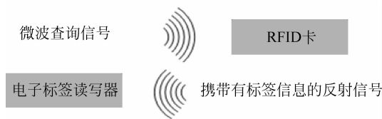
图 3-15 RFID 工作原理
