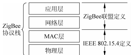
图 3-13 ZigBee 协议栈结构
