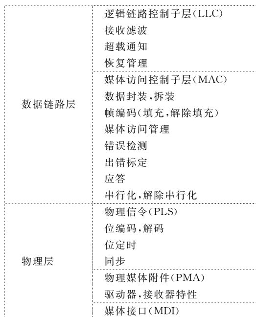
图 3-29 CAN 协议的分层结构
