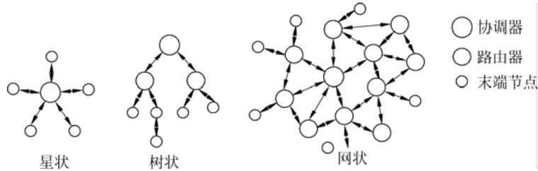
图 3.4 ZigBee 组网拓扑结构
