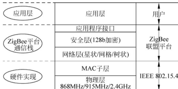
图 3.3 ZigBee 协议栈
