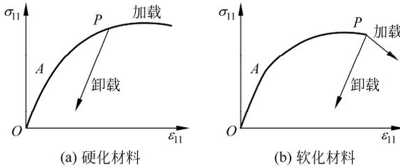
图 1-3 硬化与软化材料单向拉伸曲线
