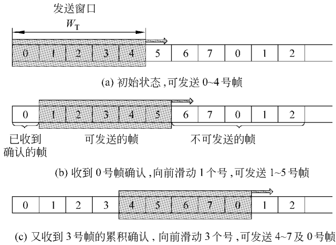
图 3.2 发送方的滑动窗口
